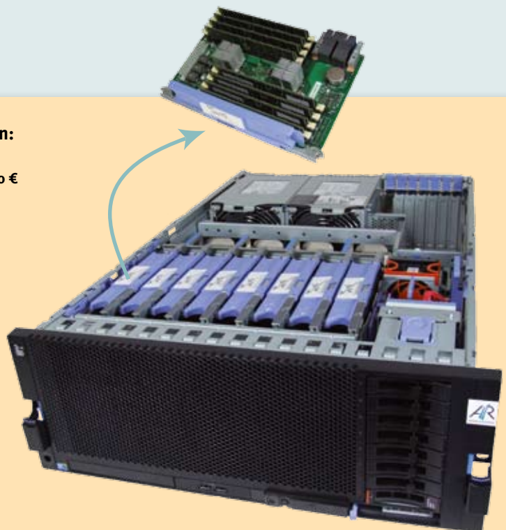
Abb.: Ariane 640 X5 mit 64 Steckplätzen für RAM-Module
